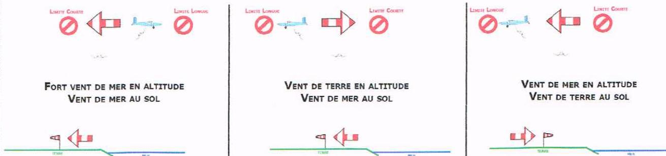
**SI LA ZONE LE PERMET, UNE SOLUTION CONSISTE À LARGUER VENT DE TRAVERS PLUS OU MOINS DÉCALÉ SUIVANT LA FORCE DU VENT. CETTE SOLUTION COMPORTE DE NOMBREUX AVANTAGES. ENTRE AUTRES, UNE FOIS OUVERTS, LES PARACHUTISTES NE REMONTENT PAS L'AXE DE LARGAGE EN S'ORIENTANT FACE AU TERRAIN. DE PLUS, LES TRAJECTOIRES, DUES À LA DÉRIVE EN CHUTE, NE CONVERGE PAS.**
